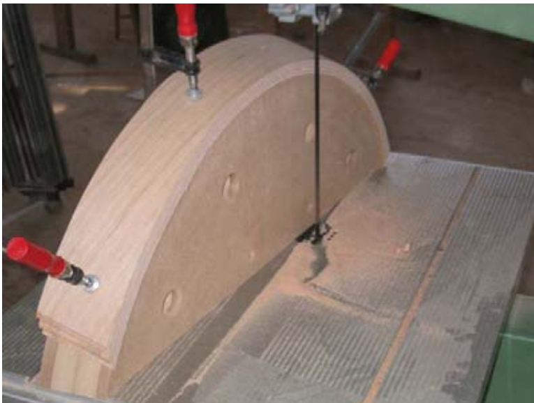
( Bild 7 vorformatieren an der Bandsäge)
