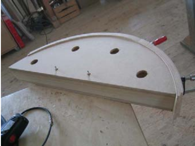
( Bild 6 Schablone zum Formatieren der 3-dimensionalen Friese)
