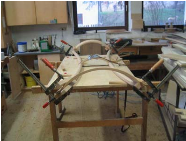
( Bild 11 Projektionsfläche verleimt und gespannt)
