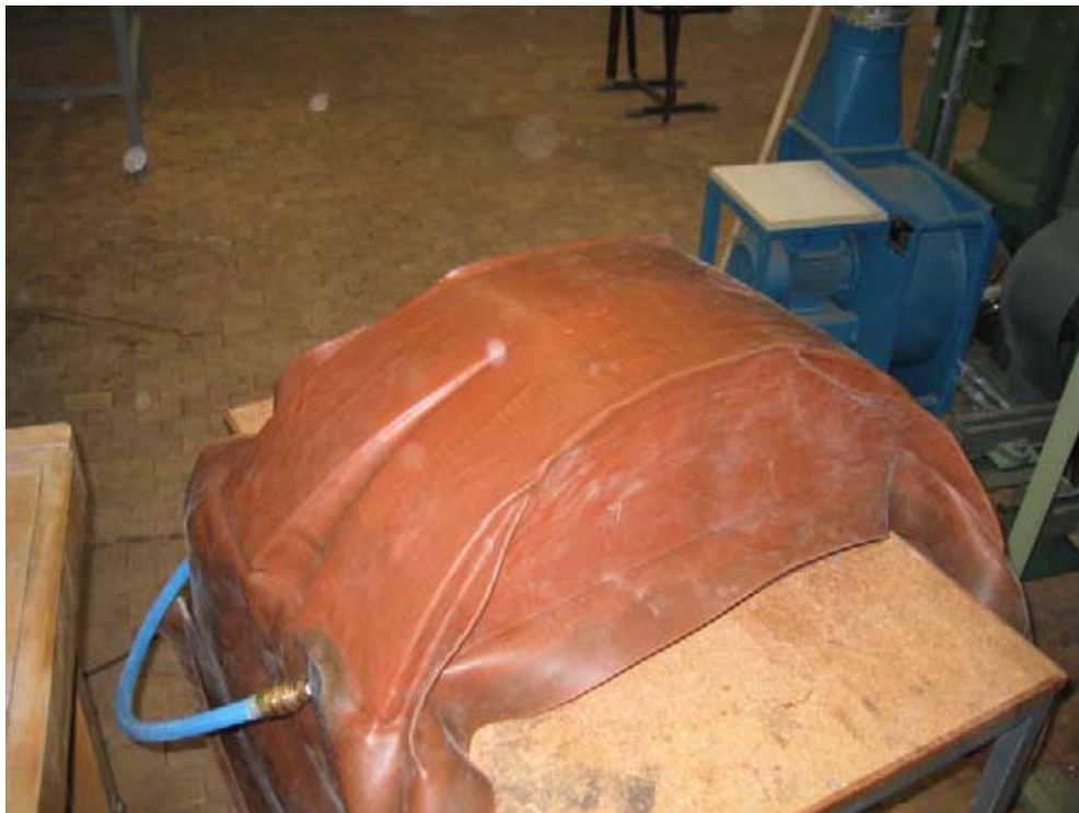
( Bild 5 Schablone mit Werkstück im Vakuumsack )
