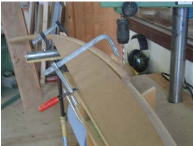
(Bild 10 bohren der aufrechten Rahmenfrieße am Bohrständler, mit schräger Schablone)
