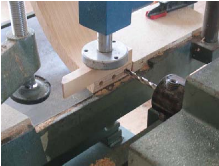
( Bild 9 anbringen der Stirnseitigen Bohrungen auf der Langlochbohrmaschine)
