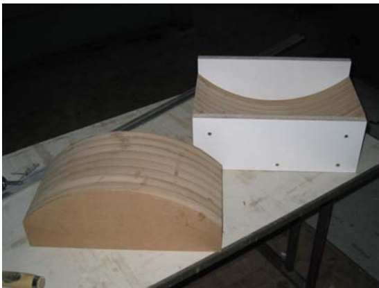
( Bild 3 Schablone und Gegenschablone für Pressung in der Furnierpresse)
