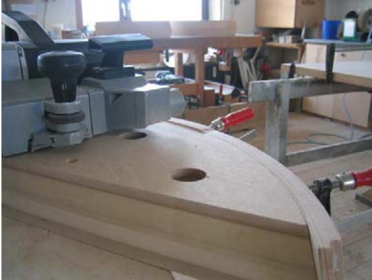
( Bild 8 exaktes Formaten mit der Bündighobelmaschine)
