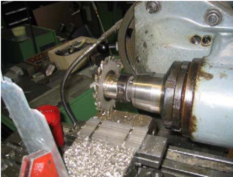
( Bild 14 fräsen der Steckverbindung)
