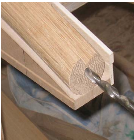
( Bild 1 Stirnseitige Bohrung in aufrechtem Fries)
